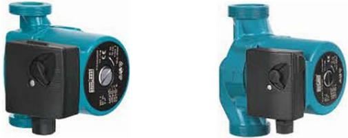
Это 3-ступенчатый циркуляционный насос, который может использоваться как в открытых, так и в закрытых системах. Насос имеет тип с мокрым ротором, т.е. насос и двигатель образуют единое целое без уплотнения вала и только с двумя уплотнительными прокладками. Перекачиваемой жидкостью смазываются подшипники. Насосы предназначены для циркуляции жидкостей в системах отопления и кондиционирования воздуха.
