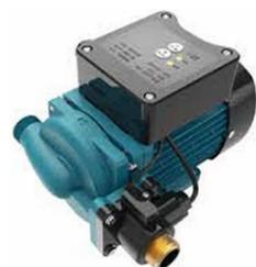
Двойное управление: для управления запуском насоса используются как переключатель расхода, так и датчик давления. Датчик давления обеспечивает мгновенный запуск. Переключатель расхода решает проблему частых запусков/остановок.
