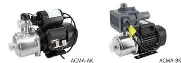
Автоматическая насосная станция с двойным регулированием расхода/давления - без частых запусков/остановок. Насос может запускаться при малом расходе (40-501 л/ч), насос останавливается при закрытии выпускного отверстия. Задержка запуска, защита от перегрева, защита от сухого хода, защита от влаги при предварительном нагреве. Манометр предоставляется по запросу
