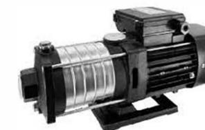
Это несамовсасывающий горизонтальный насос для станков с двигателем с удлиненным валом. По желанию заказчика насос может быть оснащен интеллектуальной системой защиты, которая может эффективно защитить насос от сухого вращения, отсутствия фазы и перегрузки. Компактная конструкция обеспечивает меньший размер насоса, осевой вход и радиальный выход.
