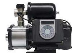
Комплекты для постоянного повышения давления с преобразователем частоты и 1 насосом. Преобразователь частоты установлен на двигателе. Пятипозиционная муфта и манометр на стороне подачи из нержавеющей стали Aisi 304. Датчик давления подключается к преобразователю. Цилиндрический сосуд высокого давления на стороне подачи
