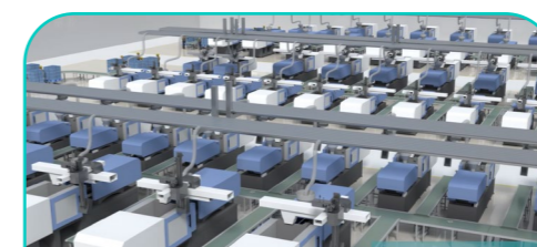
Интеллектуальный цех литья под давлением
